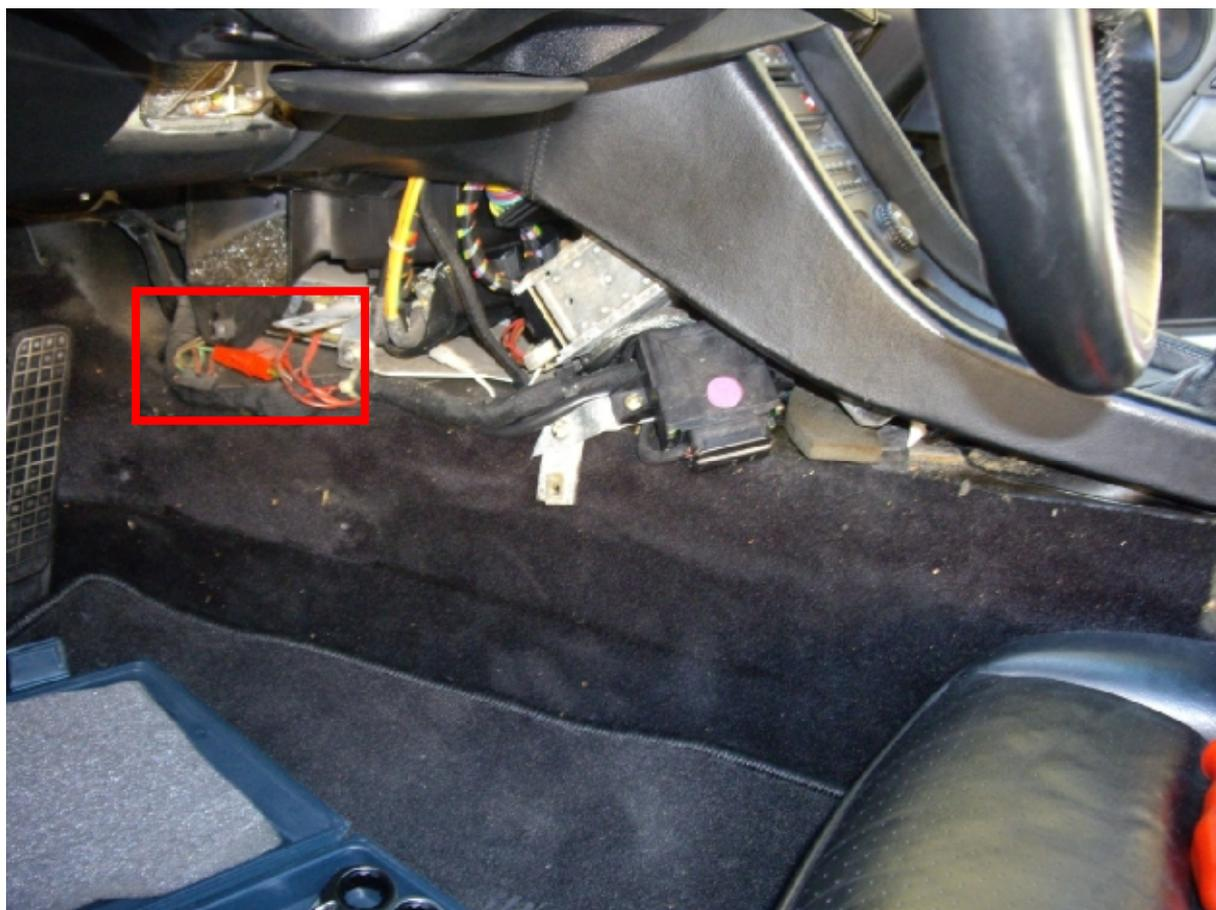
Hier siehst du dann schon die Stecker für die Fensterheber, Schiebedach und Heckwischer. Auf der Fahrerseite ist der rote Stecker für die Fensterheber links.
