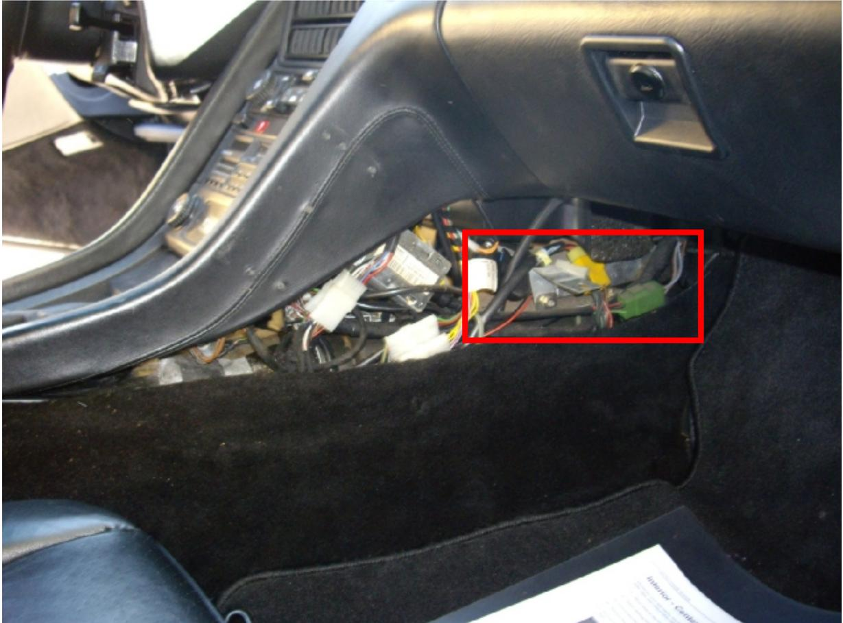
Auf der Beifahrerseite der grüne Stecker für die Fensterheber rechts, der gelbe Stecker für das Stahlschiebedach und der weiße Stecker für den Heckwischer.
