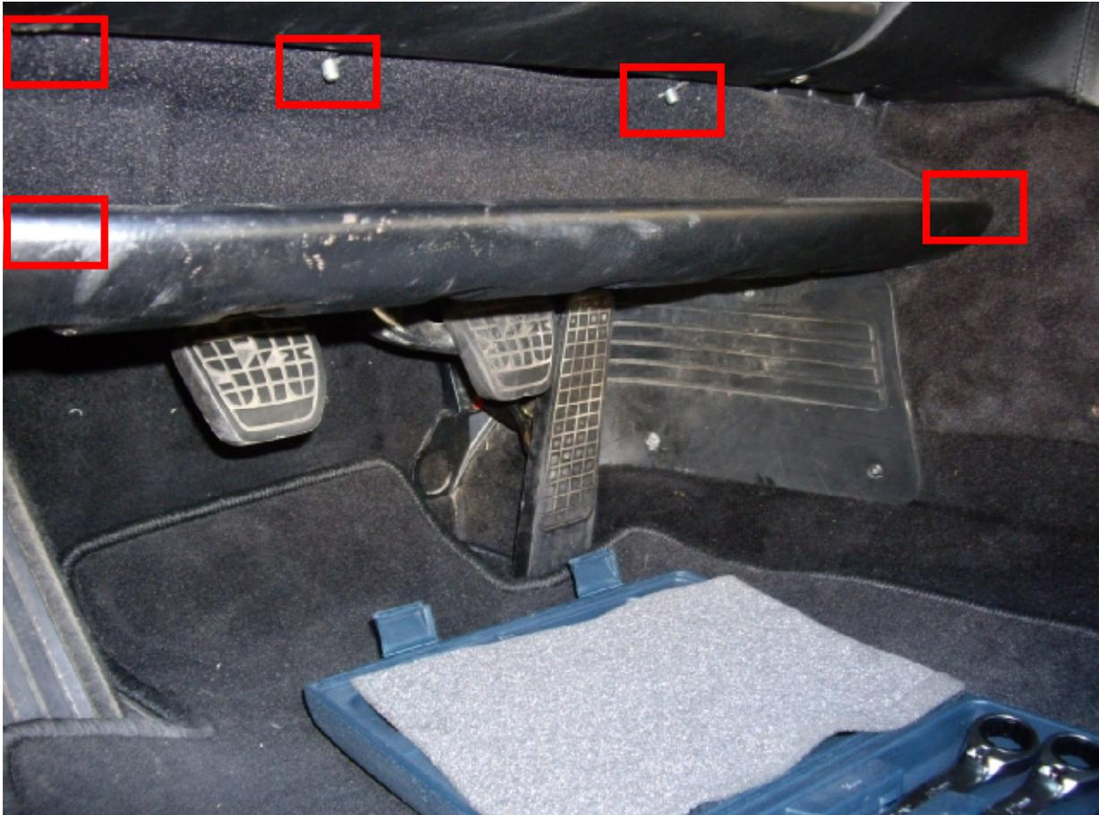
Dazu die 3 Schrauben unter dem Armaturenbrett lösen. Außerdem ist das Ablagefach noch mit je einer Schraube an beiden Seiten befestigt. Von unten kommt man am Besten ran.
