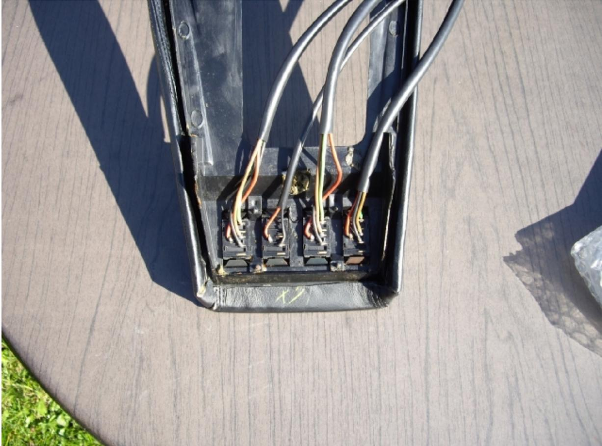
Um die Schalter herauszunehmen, einfach mit einem Schraubenzieher gegen die Metallbügel drücken. Die Schalter springen dann aus den Halterungen.
